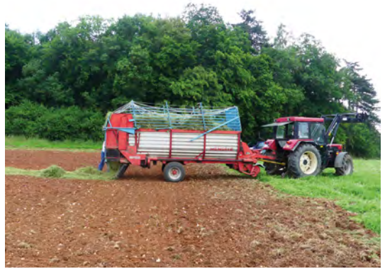
Verteilung des Mahdgutes vom Ladewagen mit Dosierwalze.
