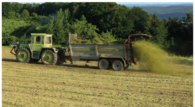
Eine weitere Möglichkeit ist die Aufnahme des geschwadeten Mahdgutes mit dem Feldhäcksler und Beladen des Miststreuers.
