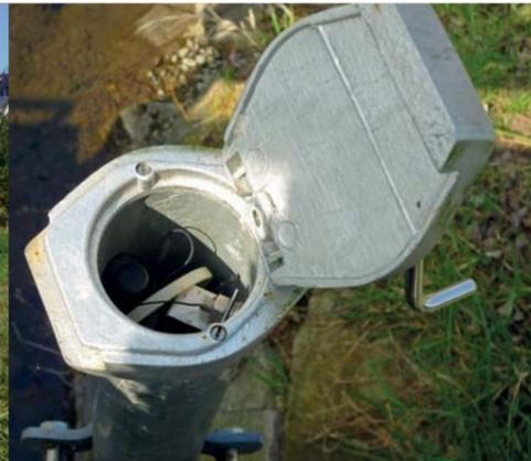
Innenansicht eines Grundwasserpegels mit Datenfernübertragung
