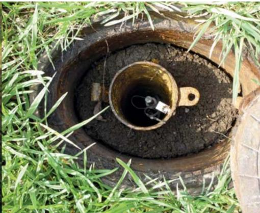
Grundwassermessstelle mit Abschluss auf Geländehöhe
