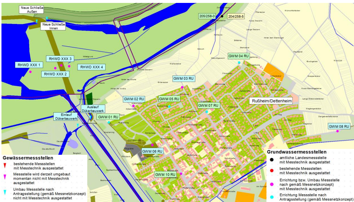
Abb. 3 Messstellenausbau Rußheim/Dettenheim (Teilausschnitt)
