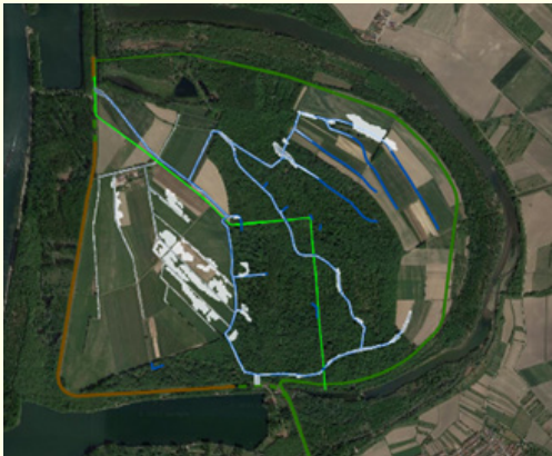
Visualisierung der Überflutungstiefen bei Abfluss-Stufe 2 (im Mittel ca. 90 Tage pro Jahr): Schluten teilweise durchströmt, Hauptweg passierbar (Ingenieures. Prof. Kobus und Partner GmbH)
