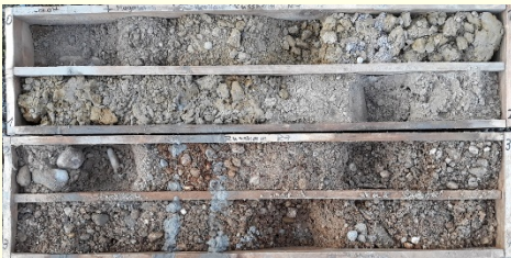
Kernkiste mit Bohrkernen des Untergrundaufbaus an einem vorgesehenen Brunnenstandort (CDM Smith Consult GmbH)
