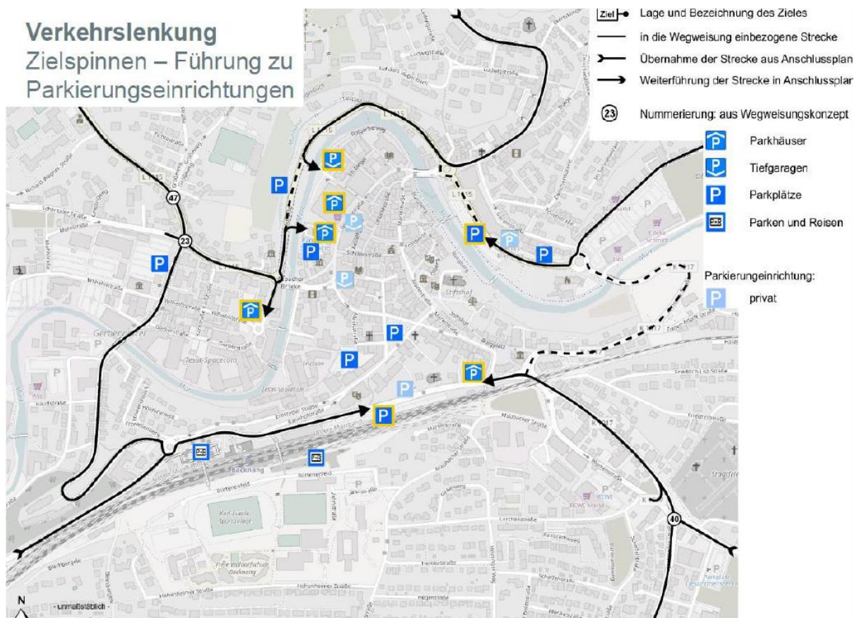
Abbildung 9: Schematische Ausgestaltung der dynamischen Beschilderung für das Parkleitsystem in der Backnanger Innenstadt
