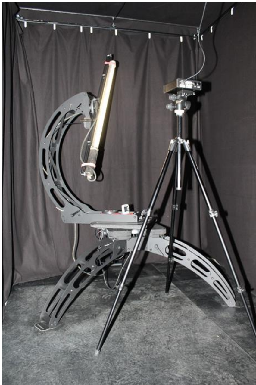
Bild: Photogoniometer zur Messung von Lichtquellen
