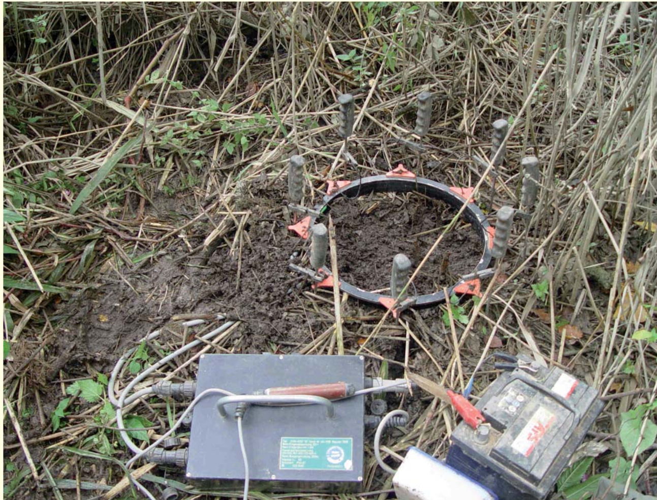
Abbildung 1: Beispielbild eines elektrischen Wurmfanggeräts mit der Oktettmethode im Einsatz.
