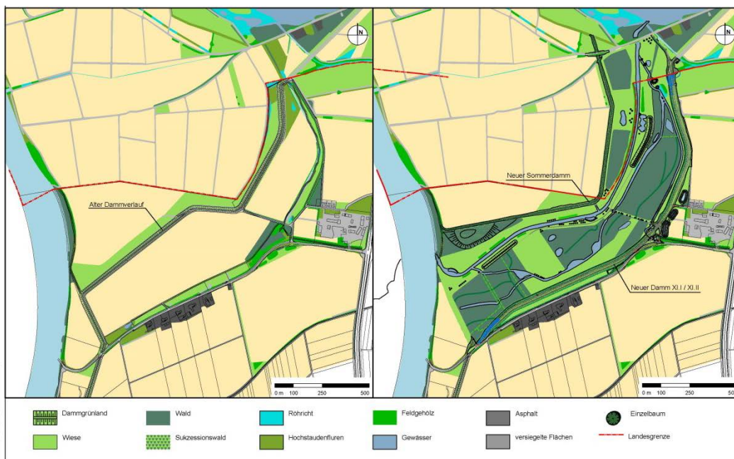
Abb. 2: Vergleich Dammrückverlegung Kirschgartshausen (links: früher ; rechts: heute) (Quelle: IUS Weibel & Ness GmbH)
